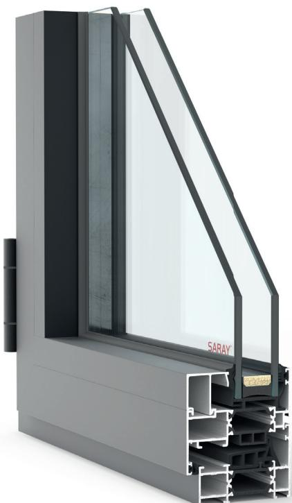
Farklı iklim koşullarına karşı her mevsim yüksek ısı dayanımı sağlayan EWT 70 Kapı Pencere Sistemleri, 3 odacıklı yapısı ve poliamid ısı bariyerinin yanı sıra, 1,5 mm ve 2,0 mm et kalınlığında iki alternatifli profil yapısı ile tüm yapı türlerinde kullanıcılarla yüksek konfor sunar. 70 mm profil derinliğine sahip EWT 70 sistemi, 58 mm'ye kadar cam kullanılmasına da olanak verir.
